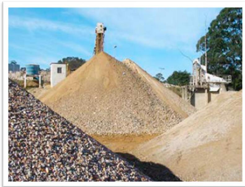
Durante o processo, há eliminação de material metálico ferruginoso pela ação de um eletroímã. Em seguida o material é estocado no pátio, para posterior expedição. Quanto à destinação do material processado, o percentual em torno de 90% do material produzido pode ser utilizado em obras públicas da própria Prefeitura, e 10% poderá ser comercializado.
